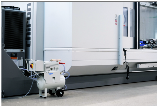
Unità a vuoto VAGG per la generazione di vuoto su un centro di lavorazio... CNC
